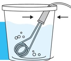
Para un óptimo funcionamiento, evite que el agua toque la parte plástica
